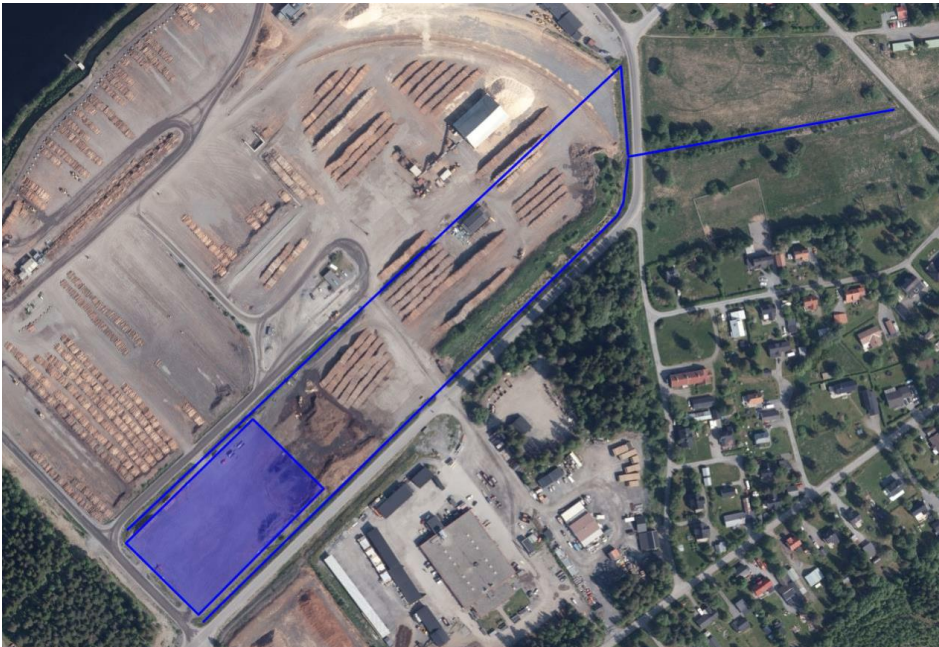
Figur 8-5 Blå rektangel visar ytan där bevattning sker. Blå linjer visar på dikena som leder bort från ytan.
