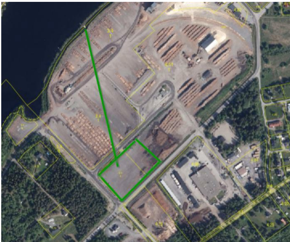
Figur 8-4 Skiss över ledningen från pumpstationen (markerad med grön linje) till bevattningsytan (markerad med grön rektangel). Kartunderlaget kommer från Lantmäteriets kartmaterial (Lantmäteriet).
